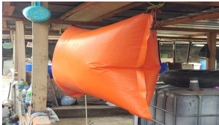
Gambar 8. Kantong penampungan gas metan
