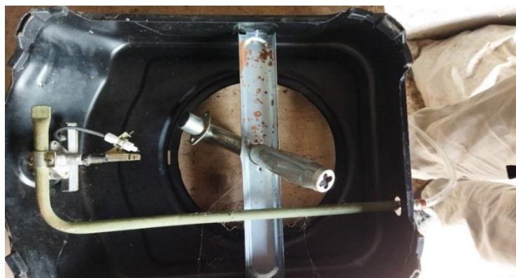
Gambar 9. Hasil modifikasi kompor bahan bakar biogas
