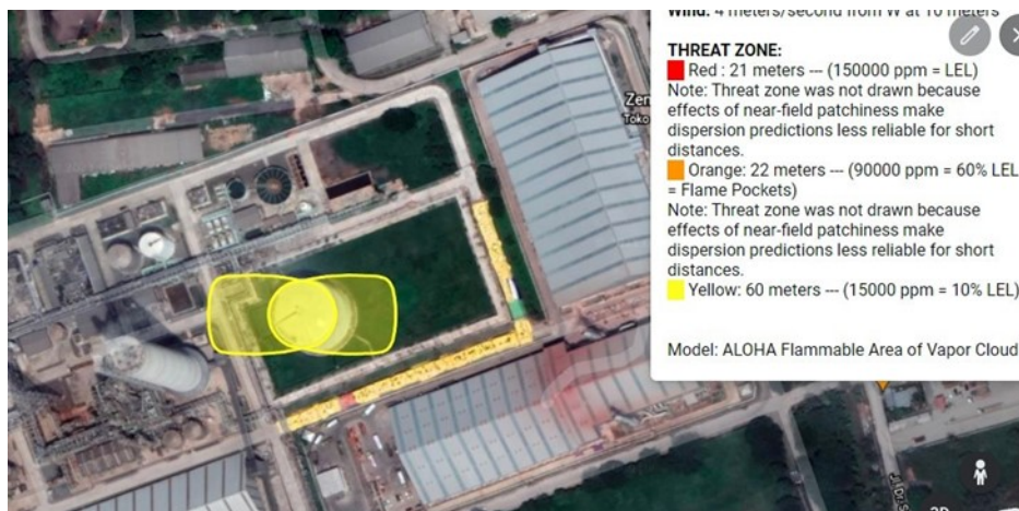
Gambar 17. Hasil map plotting dari threat zone ALOHA ke wilayah tangki untuk flammable area of vapor cloud pada musim kemarau
