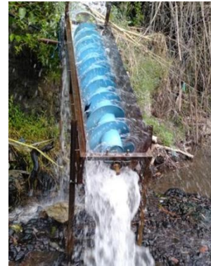
Gambar 8. Implementasi turbin di lokasi pengujian dengan sudut 35°
