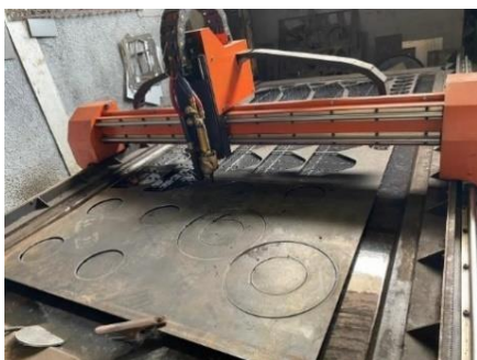
Gambar 3. Pemotongan sudu dengan plasma cutting .
