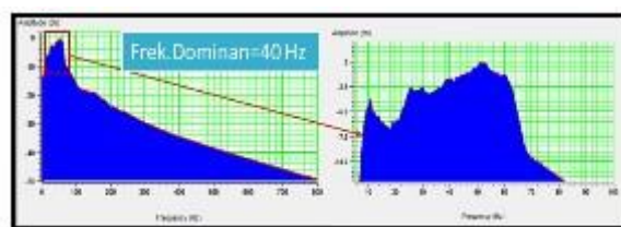
Gambar 4. Frekuensi dan amplitude spectrum seismik setelah proses enhancement (Frekuensi setelah enhancement sebesar 40 Hz dan sebelum enhancement sebesar 15 Hz)
