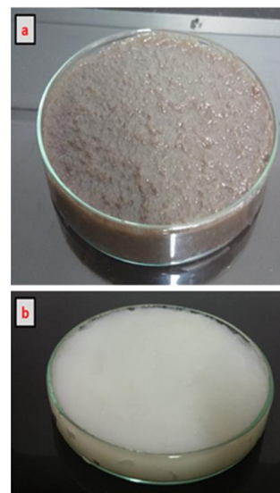
Gambar 2. (a) Warna endapan setelah proses praperlakuan basa. (b) Warna endapan setelah proses pemutihan.
