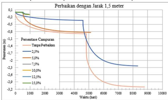
Gambar 17. Penurunan dengan Jarak Perbaikan 1,5 meter
