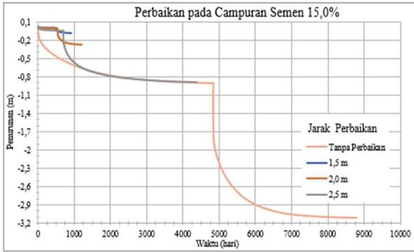
Gambar 16. Penurunan dengan Perbaikan Campuran 15,0%
