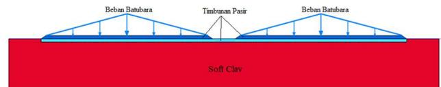
Gambar 3. Pemodelan Tanpa Perbaikan
