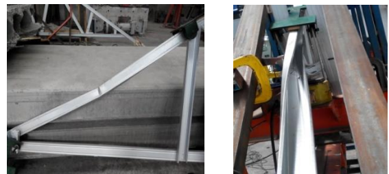
Gambar 13. Kegagalan struktur rangka kuda-kuda
