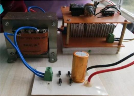
Gambar 7. Realisasi rangkaian pada PCB untuk implementasi SHF.
