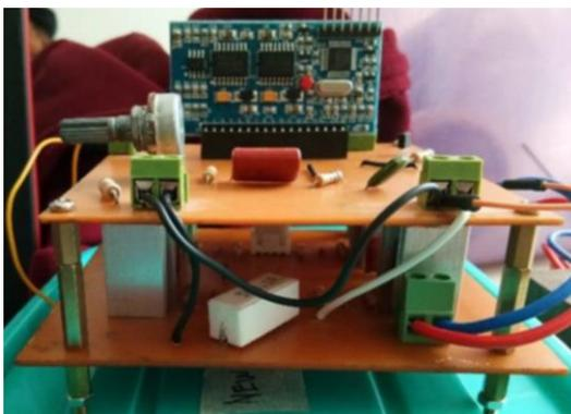
Gambar 8. Realisasi rangkaian pada PCB untuk implementasi SPWM.
